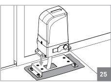
02 • Coloque o motor na chapa de fixação.
