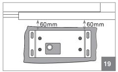
**01 •** Coloque a chapa de fixação em cima da sapata e alinhe-a paralelamente ao portão mantendo uma distância de 60mm entre eles como visível na figura 19.
