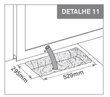
01 • Faça um buraco no solo para criar uma sapata em betão. As dimensões apresentadas são as recomendadas na criação da sapata. Deve deixar tubos no meio do buraco para a passagem de cabos para alimentação e acessórios, como mostra na imagem 11.
