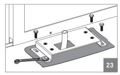
**04** • Coloque a chapa de fixação na sapata de betão respeitando as distâncias da imagem 19. Utilize um nível para a nivelar horizontalmente e aperte-a com os parafusos M10.
