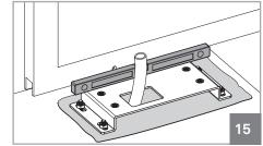
04 • Insira a chapa com os parafusos na base de betão ainda fresco e nivele-a horizontalmente com um nível. Alinhe-a também paralelamente ao portão mantendo uma distância de 60mm entre eles, como vísivel na imagem 16.
