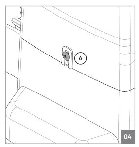
Durante a instalação será necessário abrir a tampa do motor, para aceder aos vários componentes no interior. Para isso, desaperte um pouco os 2 parafusos, identificados com (A) até que a tampa fique livre para ser retirada.
