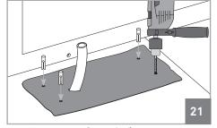
**03** • Faça quatro furos de Ø18mm na sapata. Coloque as buchas metálicas M10 nos furos.
