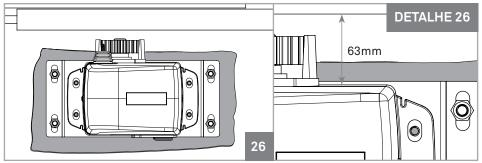
**03** • Alinhe-o paralelamente ao portão deixando uma distância de 63mm entre eles como visível na imagem 26. Os furos ovalizados do motor devem ficar centrados com os furos roscados na chapa de fixação, como visível no DETALHE26.
