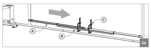
05 • Feche um pouco mais o portão, deixando a cremalheira de estar apoiada sobre o pinhão e aplique outro pedaço de cremalheira (A). Para sincronizar os dentes com o pedaco já instalado, utilize um pedaco adicional de cremalheira (B) e coloque-o por baixo da união dos outros dois, segurando-os com grampos (C).
