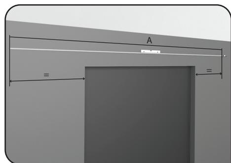
**02** - Colocar as medições na parede e confirmar o nivelamento.
