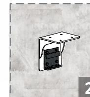
**2** Faça a fixação na consola individual usando parafusos M12 com anilhas (**outra opção ver detalhe B**).
