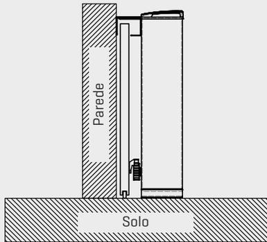
A base do motor fica alinhada pelo limite inferior do portão no local de instalação.
