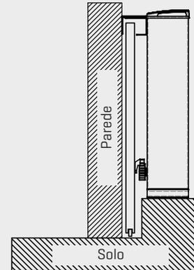
A base do motor fica acima do limite inferior do portão no local de instalação.
