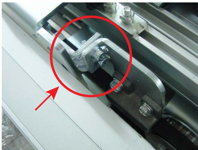
Desaperte os dois parafusos DIN912 M5 mostrados nas imagens acima.
