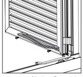
**04 •** De seguida deve fixar as chapas nas portadas. Estas devem ser fixas utilizando dois parafusos, e respeitando as dimensões que surgem na imagam **A** e **B**.
