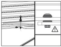
**05** • Unir os braços com as chapas das portadas, utilizando as peças de fixação como vísivel nas imagens acima.
