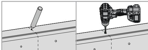
**02.** Marque e faça uma furação na parte superior do cofre para passagem do cabo do interior para o exterior.
