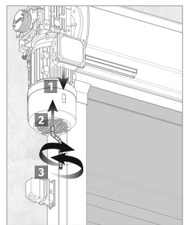
Para abrir ou fechar manualmente a porta, basta puxar e segurar a alavanca de desbloqueio, e inserir a manivela, para rodar o parafuso instalado na parte inferior do motor (ver imagem).
