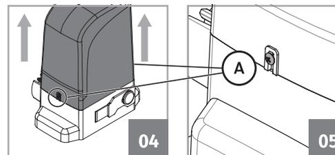
Durante a instalação será necessário abrir a tampa do motor, para aceder aos vários componentes no interior. Para isso, desaperte um pouco os 2 parafusos, identificados com (A) até que a tampa fique livre para ser retirada.
