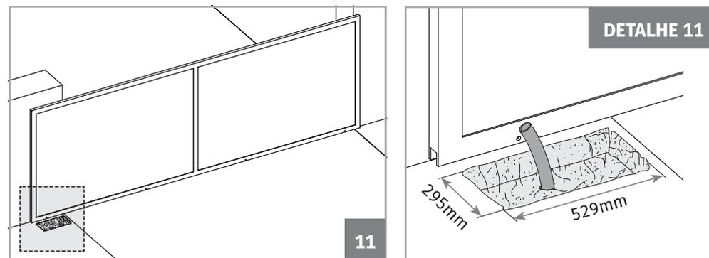
**01** • Faça um buraco no solo para criar uma sapata em betão. As dimensões apresentadas são as recomendadas na criação da sapata. Deve deixar tubos no meio do buraco para a passagem de cabos para alimentação e acessórios, como mostra na imagem 11.
