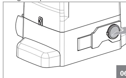
01 • Abra a tampa de proteção do canhão de desbloqueio.
