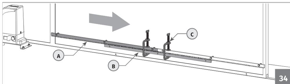
**05** • Feche um pouco mais o portão, deixando a cremalheira de estar apoiada sobre o pinhão e aplique outro pedaço de cremalheira (A). Para sincronizar os dentes com o pedaço já instalado, utilize um pedaço adicional de cremalheira (B) e coloque-o por baixo da união dos outros dois, segurando-os com grampos (C).
